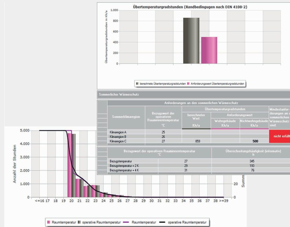
Abb. 4 Jahres-Übertemperaturgradstunden der Raum- und operativen Temperaturen zum Nachweis des Sommerlichen Wärmeschutzes nach DIN 4108-2 mittels thermischer Gebäudesimulation mit Norm-Randbedingungen.
