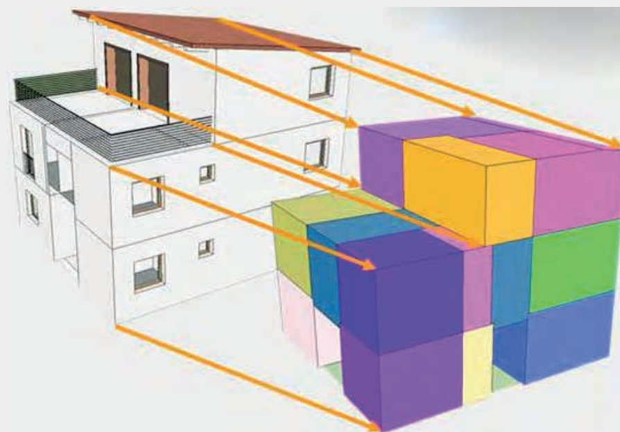
Abb. 27 3D-Ansicht eines eingelesenen oder zeichnerisch neu erfassten Architekturmodells im „Raumtool3D“. Das Tool erkennt Räume und Bauphysik-Bauteile mit Nachbarraumbeziehungen und angepassten Abmessungen, wie sie für SOLAR-COMPUTER Berechnungen notwendig sind.
