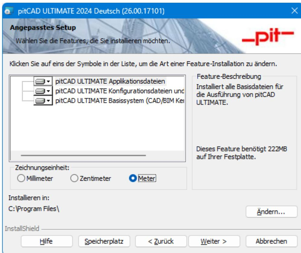
Wählen Sie aus dem Menü aus, welche Features von pitCAD ULTIMATE 2024 Sie installieren möchten. Und welche Standardzeichnungseinheit standardmäßig verwendet werden soll.
